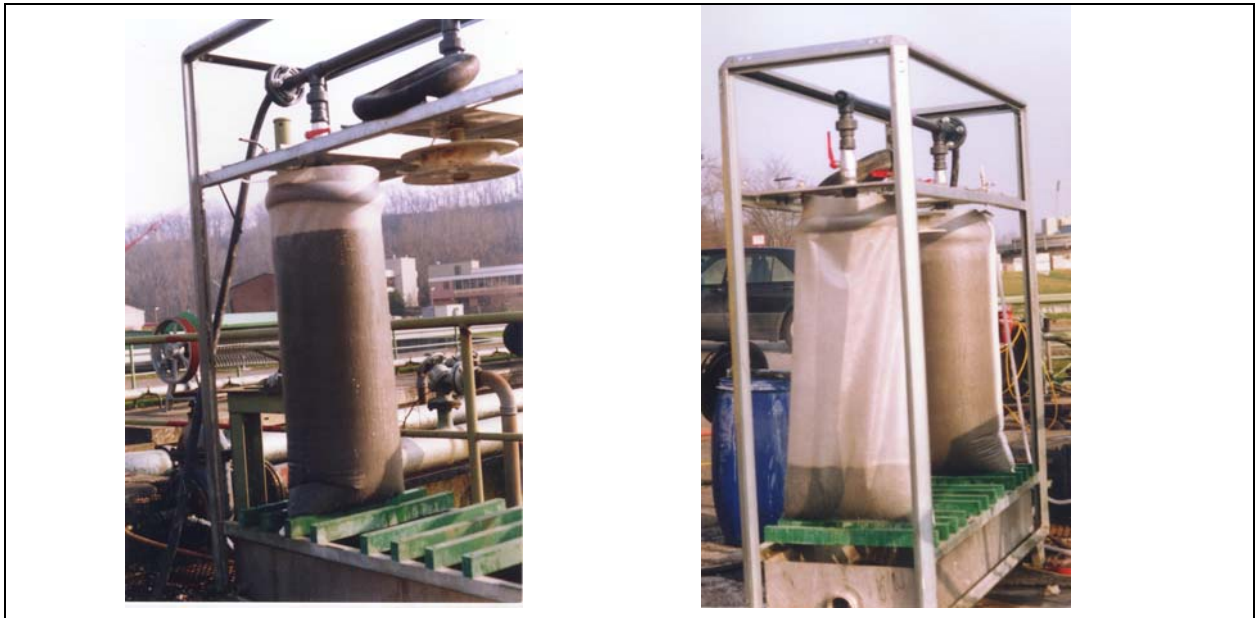
Bild 8.1: Absackvorrichtung der MAP-Pilotanlage zur Zentratwasserbehandlung der Kläranlage Stuttgart-Mühlhausen (NALVA, 1992)
