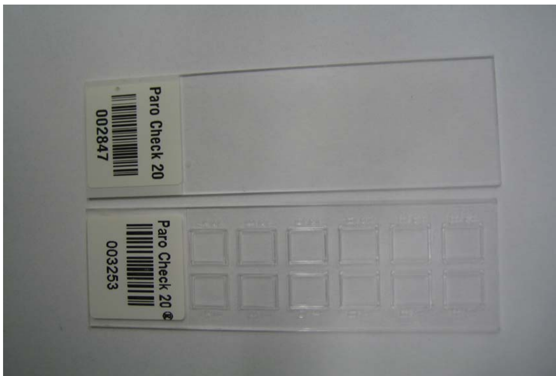
Abbildung 20: Der ältere Chip (oben) zur Aufnahme einer Probe und der neuere Chip (unten) mit zwölf Spots zur Aufnahme einer Patientenprobe
